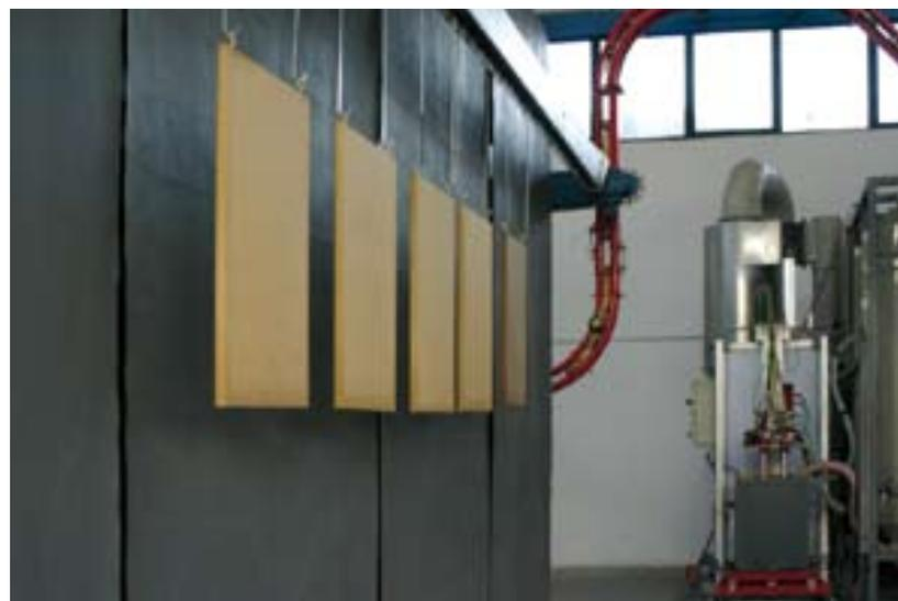
6 – Una volta usciti dal tunnel di asciugatura (a sinistra), la bilancella trasla fino alla prima postazione di verniciatura. A destra nella foto si vede la cabina d'applicazione.
