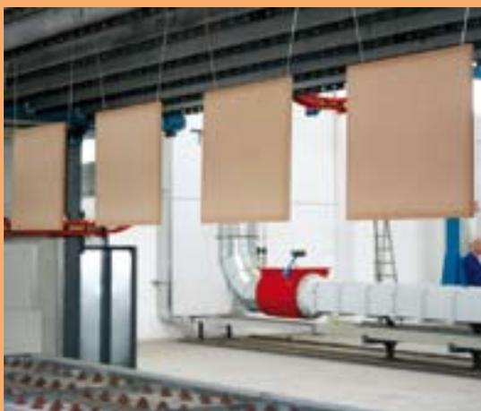
3 - Le antine nel tunnel "a capannetta" di asciugatura: sul fondo le bocchette dell'aria ambiente.
