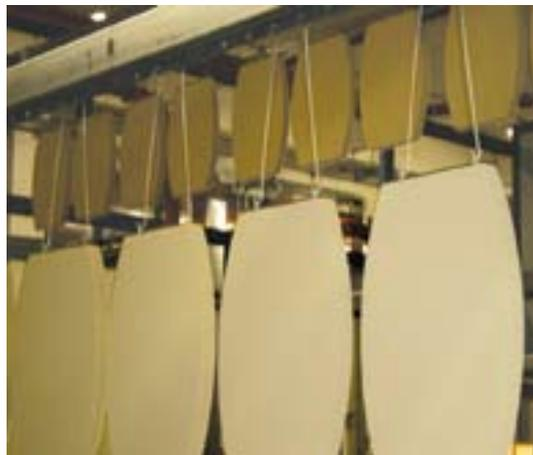
polimerizzazione, sono caratterizzate da notevole capacità di distensione. Anche in questo caso, il forno a tunnel effettua il movimento di andata e ritorno a pezzi fermi (fig. 11).
