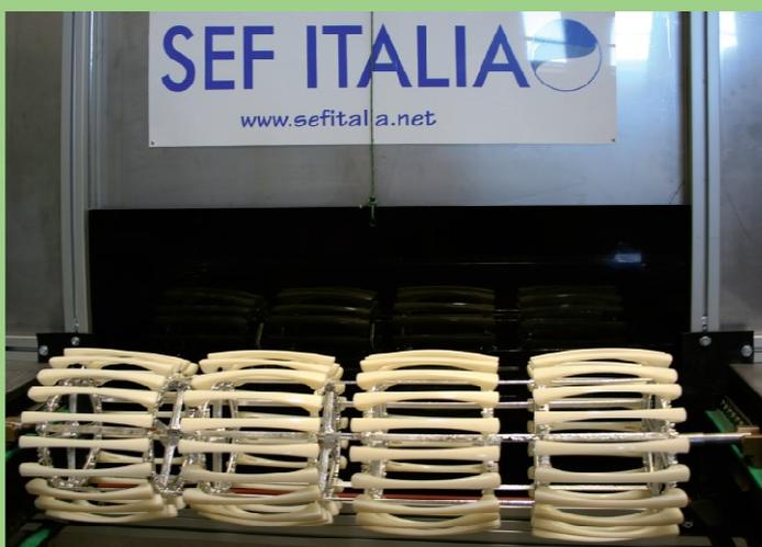
3- Primo piano del telaio portapezzi, con i manufatti verniciati con il primer trasparente.
