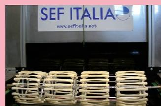
Primo piano del telaio portapezzi con i manufatti verniciati con il primer trasparente.
